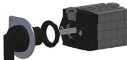
*Nota: La profundidad del interruptor estará determinada por el número de módulos que posea; la siguiente tabla muestra las dimensiones para configuraciones hasta 4 módulos. El cuello central es de 22 mm, por lo cual para su instalación debe ser realizada una perforación de 22,5 mm de diámetro.*
