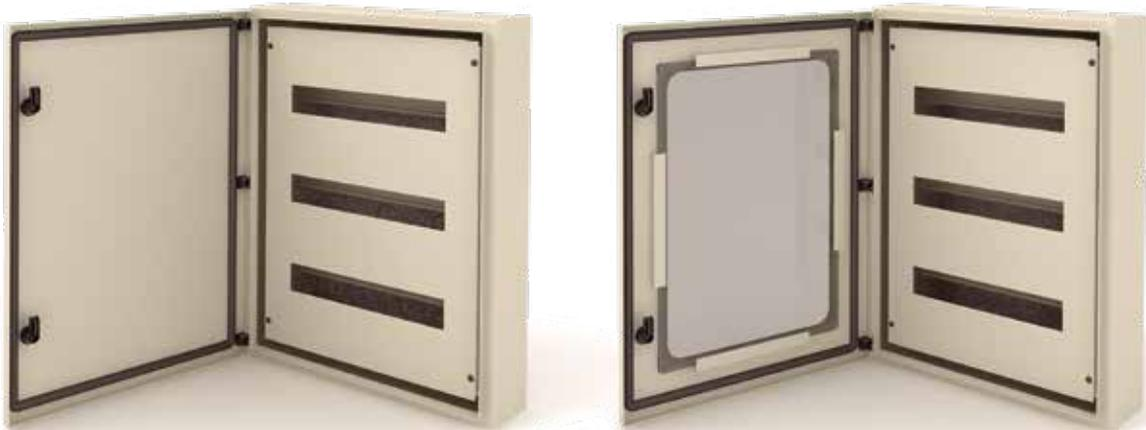
Destinados a la instalación de elementos contruidos según formato DIN. Son gabinetes de 100 mm de profundidad útil con contrafrente calado y rieles DIN abulonados a la bandeja para la fijación de elementos.
