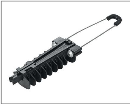
La morsa de retención PRA-1500 está diseñada para la retención de conductores preensamblados de baja tensión y redes compactas MT. Soporta esfuerzos de hasta 1800kg. Cumple con todas las exigencias de las normas nacionales e internacionales. Permite sujetar conductores de 50 a 70 mm<sup>2</sup>. Fabricada en Nylon 6/6, con cables de acero de gran resistencia, el uso de esta morsa garantiza la mas sólida y confiable fijación.
