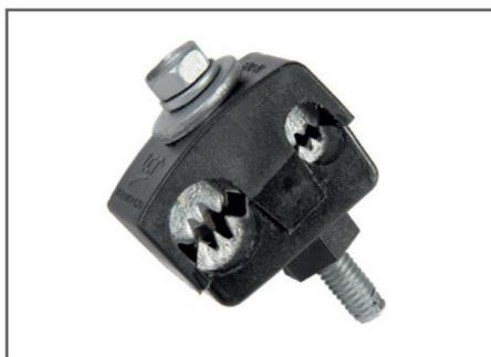
Morseto aislado para derivaciones entre un cable preensamblado de aluminio y un conductor de aluminio o cobre. Su tamaño y rango lo hacen ideal para realizar derivaciones en acometidas domiciliarias. De simple instalación, no requiere el pelado previo de los conductores, ya que sus dientes penetran en la aislación realizando así el contacto.
