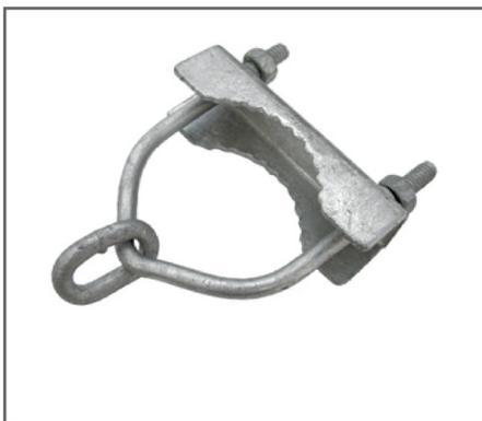
Abrazadera para pilar domiciliario, para caños de pilar con un Ø máximo 48mm, diseñada con una planchuela de base dentada para asegurar la fijación de la misma al caño.
