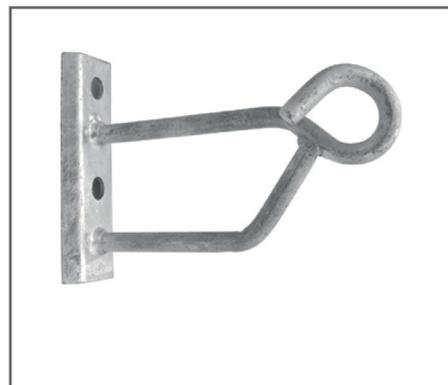
Ménsula de suspensión, fabricada en hierro de Ø 14 mm, lo cual garantiza una óptima resistencia a la tracción. De fácil instalación, permite fijación a pared por medio de un bulón, o a poste/columna utilizando una abrazadera PKD-30/31/32.
